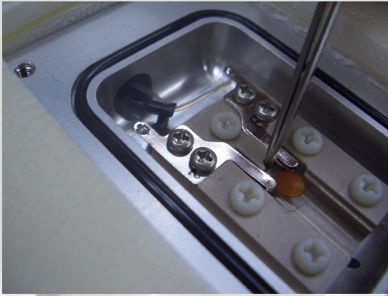
【サンプル部】 水晶振動子に薄膜を形成してセットします。
